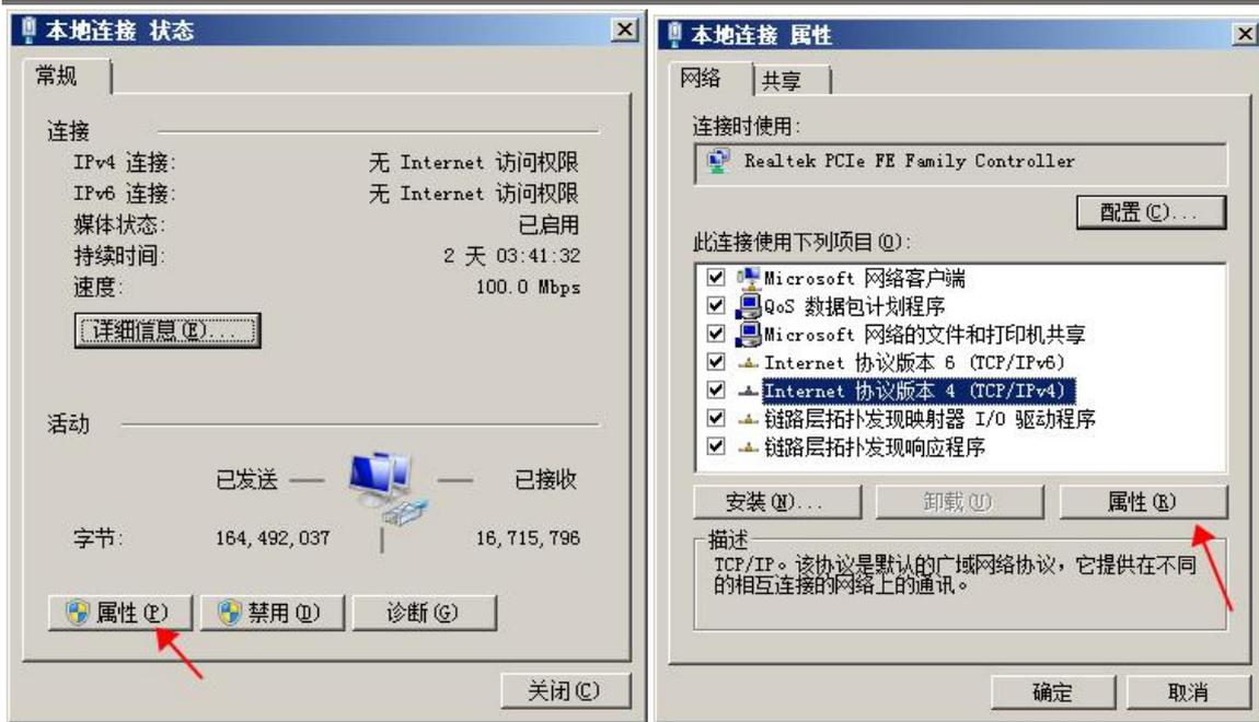
手动修改 IP 地址如下图所示，或者点击自动获取 IP 地址由路由器 DHCP 自动分配。
